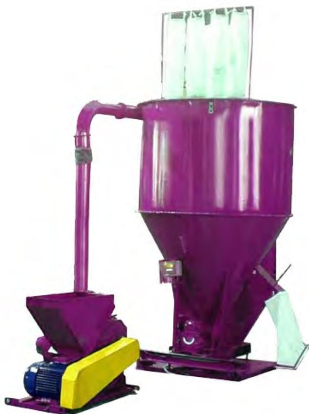
Предназначен для измельчения фуражного зерна влажностью не более 17% и смешивания измельченной массы с витаминно-минеральными добавками в соответствии с зоотехническими требованиями для всех видов и возрастных групп животных, птицы и рыбы.
