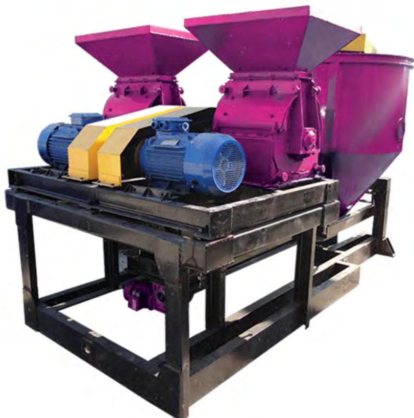
Предназначен для приготовления рассыпных комбикормов из зернофуража (пшеница, ячмень, горох, кукуруза и т.д.) и БВМД. Может использоваться как отдельно, так и в составе технологических линий по производству комбикормов.
