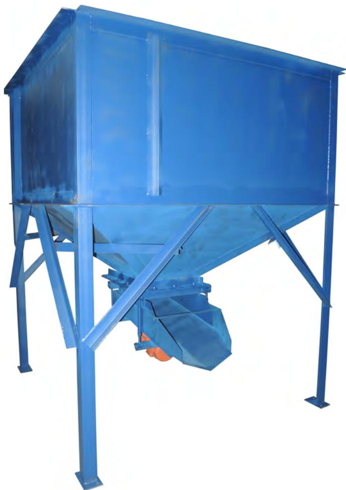
Предназначен для накопления и промежуточного хранения продукта.
