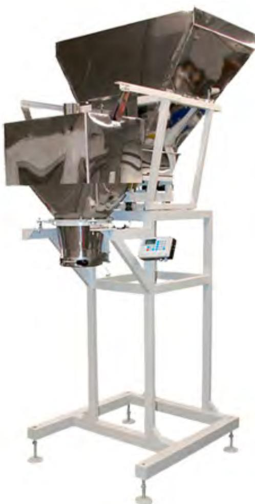
Предназначен для автоматического дозирования древесного угля в открытые мешки. Оборудован ленточным питателем, механическим зажимом мешка и зонтиком аспирации.
