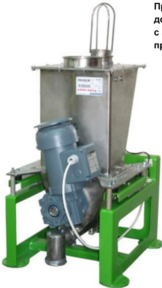
Предназначен для непрерывного весового дозирования сыпучих материалов и добавок с автоматическим поддержанием заданной производительности.
