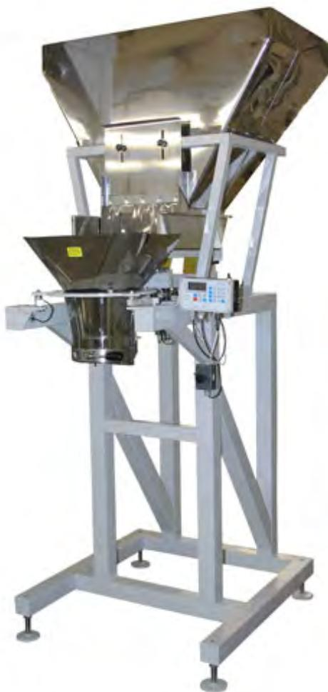
Предназначен для автоматического дозирования каменного угля с фракцией от 25 до 75 мм в открытые мешки. Оборудован ленточным питателем, механическим зажимом мешка и зонтиком аспирации.
