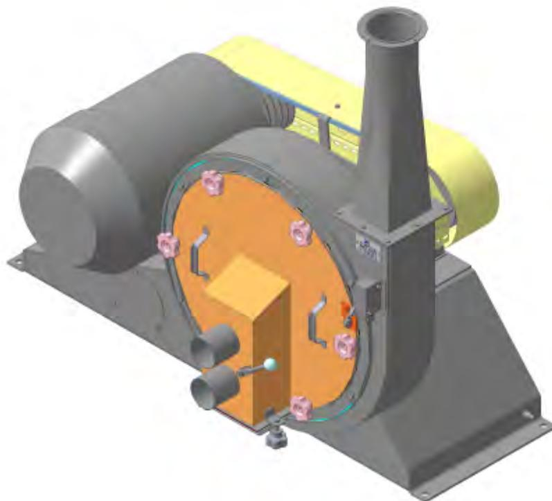
Предназначена для измельчения жмыха средней твердости с влажностью до 8%.
