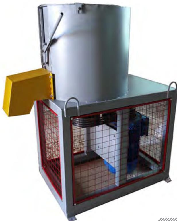
Предназначен для приготовления комбикорма и кормовой протеиновой смеси на основе рыбных отходов и растительных продуктов (зерновые отруби, крупа, шрот и т.д.).
