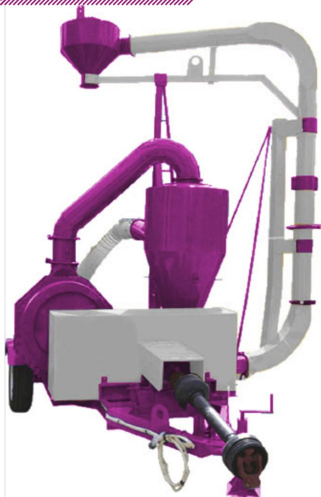
Работа перегружателя осуществляется за счет разряжения в пневмосистеме: воздух, засасываемый через заборное устройство, захватывает продукт и транспортирует его в циклон-осадитель. В результате уменьшения скорости потока продукто-воздушной смеси и центробежных сил, возникающих при изменении направления потока, в циклоне происходит отделение продукта, который через шлюзовой затвор выводится и подается в нагнетающий продуктопровод для дальнейшей транспортировки.
